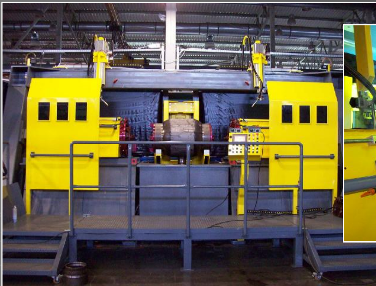
Машина для сварки двух кольцевых швов корпуса крана (Ду300 - Ду600)
